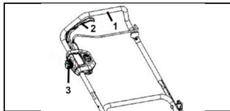
1. Oberer Griff 2. Selbstfahrender Auslöser 3. Geschwindigkeitsregler
