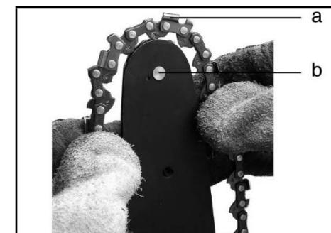
Håll styrskenan med näsan uppåt och placera sågkedjan så att kedjejhulets kedje ingriper i kedjelänkarna och de nedre delarna av drivlänkarna är belägna i spåren på stången. Kedjan är korrekt spänd när det fortfarande är möjligt att höja den med 3-4 mm. Sågkedjans rotationsriktning indikeras med två pilar på drivhjulskyddet.
