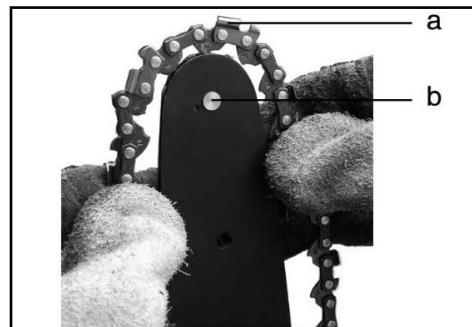
Halten Sie die Führungsstange mit der Nase nach oben und legen Sie die Sägekette so auf das Kettenrad der Führungsstange in die Kettenglieder ein, dass sich die unteren Abschnitte der Antriebsglieder in der Nut der Stange befinden. Die Kette wird korrekt gespannt, wenn es noch möglich ist, sie um 3-4 mm anzuheben. Die Drehrichtung der Sägekette wird durch zwei Pfeile auf der Antriebsritzelabdeckung angezeigt.
