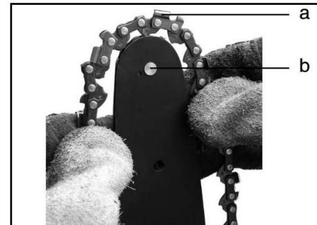
Tenez le guide-chaîne avec le nez vers le haut et placez la chaîne de scie de manière à ce que le pignon du guide-chaîne s'engage dans les maillons de la chaîne et que les sections inférieures des maillons d'entraînement soient situées dans la rainure du guide-chaîne. La chaîne est correctement tendue lorsqu'il est encore possible de la relever de 3-4 mm. Le sens de rotation de la chaîne de scie est indiqué par deux flèches sur le couvercle du pignon d'entraînement.
